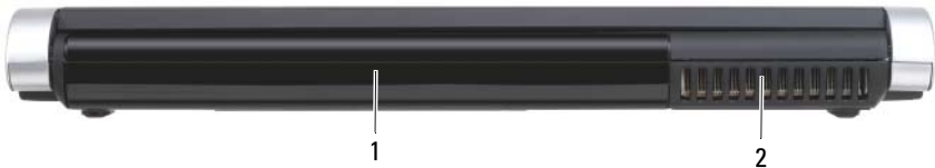
1 batterie 2 entrées d'air
